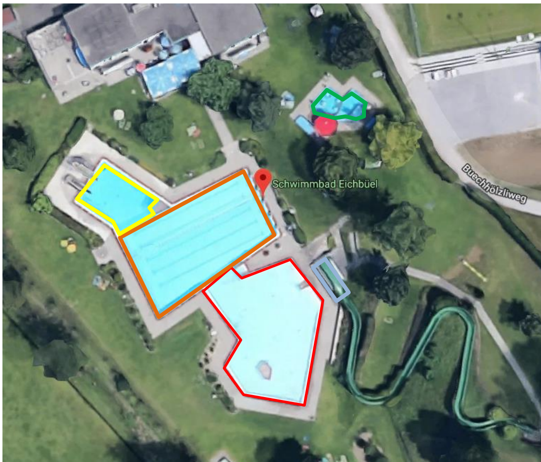
Abbildung 8: Kombibecken: rot NSB, orange SB, gelb SPB; Oben grün: PLB; Rechts: Rutschbahn mit Landezone (blau)
